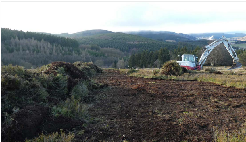
Abb. 4.3 Sieblöffel-Bagger im Einsatz auf der „Kahlen Pön“ (Foto: Benedikt Wrede, Biologische Station Hoch-Sauerland-Kreis)
