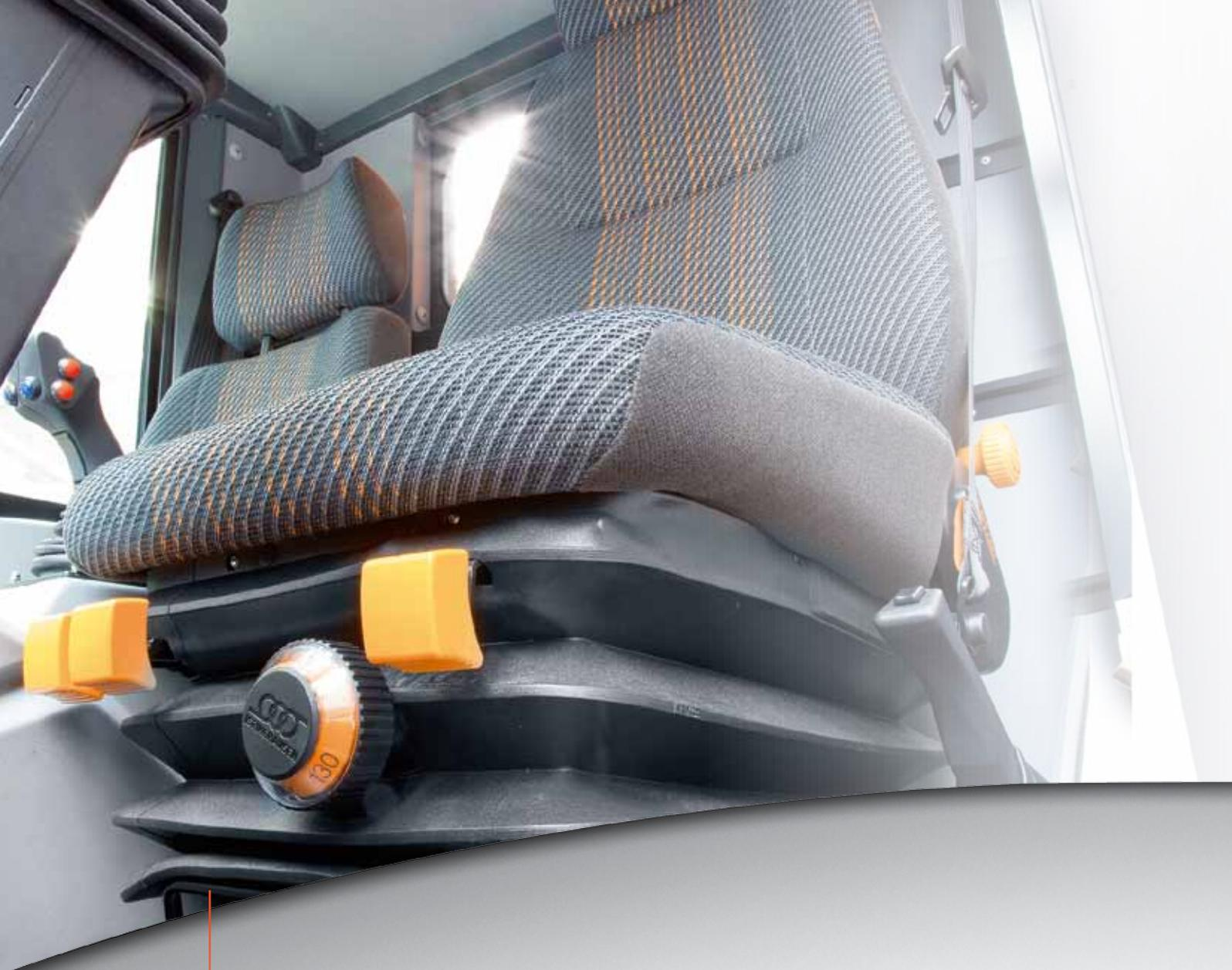
So findet jeder schnell die optimale Sitzposition: Die Komfort-Schwingsitze ermöglichen die Längs-, Rückenlehnen-, Gewichts- und Neigungsverstellung.
