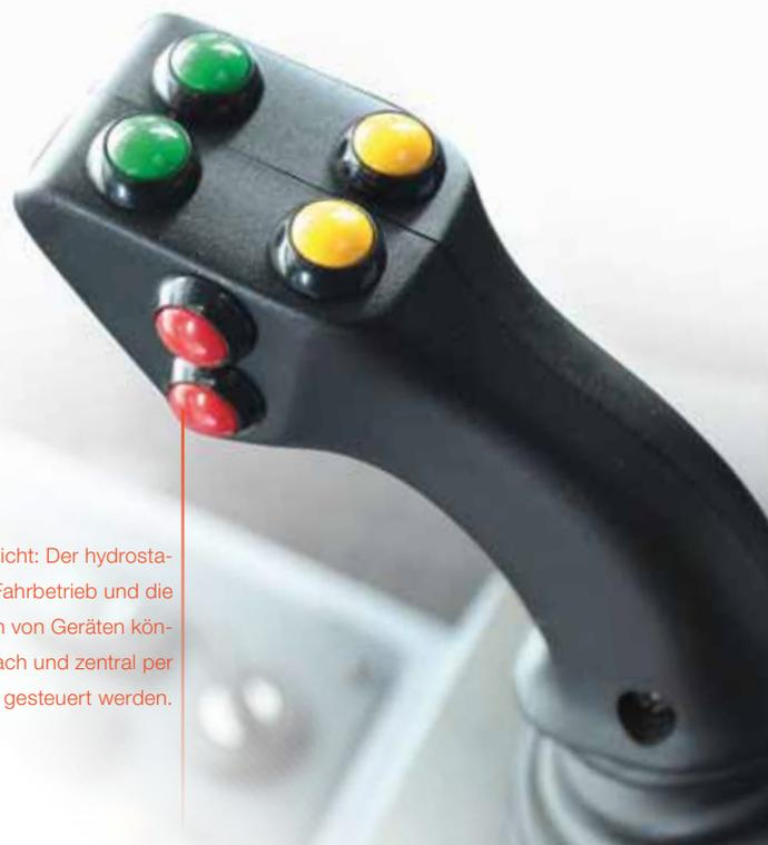
Spielend leicht: Der hydrostatische Fahrbetrieb und die Funktionen von Geräten können einfach und zentral per Joystick gesteuert werden.
