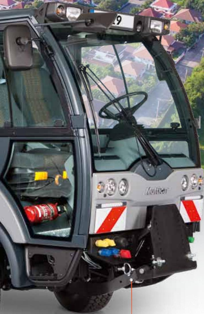
Serienmäßig auf Flexibilität ausgelegt: die Schnellwechselsysteme des Multicar M29. Im Bild: robuste Geräteplatte für Frontgeräte.
