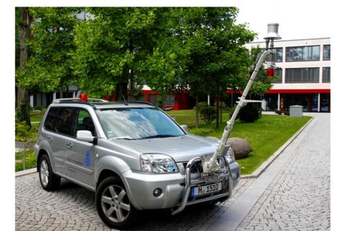
Abb. 5: Messfahrzeug des DWD.
