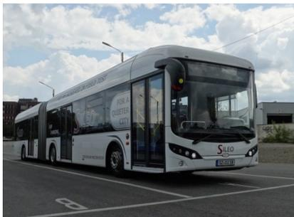
Angetrieben wird der Elektrobus an zwei Achsen von insgesamt vier radnahen Motoren mit einer Leistung von je 120 kW (480 kW insgesamt). Als Speichermedium nutzt er eine Lithium-Eisen-Phosphat-Batterie mit einer Kapazität von 300 kWh, die auf dem Dach platziert ist. Die Reichweite einer Ladung beträgt nach Herstellerangaben mindestens 250 Kilometer.
